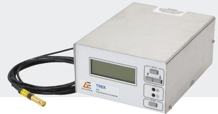
Trek® 541A 静电电压表可精确地非接触式测量与 EOS/ESD 工艺相关的静电表面电压。该仪器配置了一个微型静电场斩波探头，可以远程定位并轻松定位在工艺设备内，以便在电离或非电离环境中提供高精度、非接触、直流稳定、不受间距影响的电压测量。
